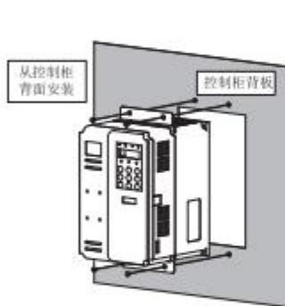
图 3-5 塑胶结构嵌入式安装示意图
