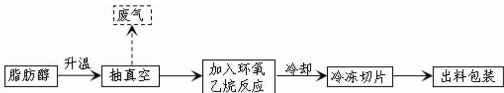
图 2-5 匀染剂平平加系列生产工艺流程图
