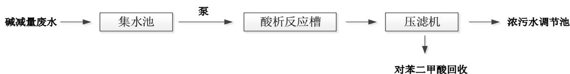
图 4.2-5 碱减量废水处理工艺流程图
