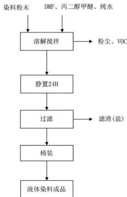
图 2-4 液体染料生产工艺流程图
