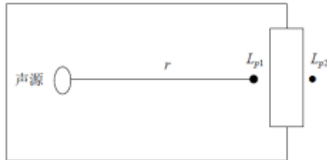
图 4-1 室内声源等效为室外声源图例
