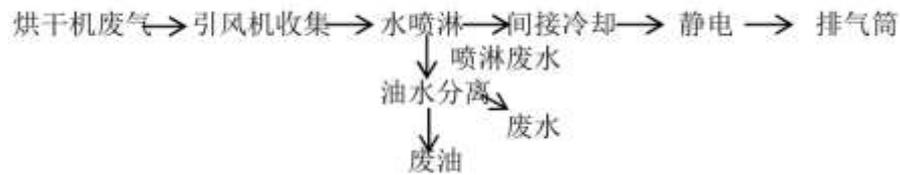
图 4.2-1 项目烘干机废气处理工艺流程图
