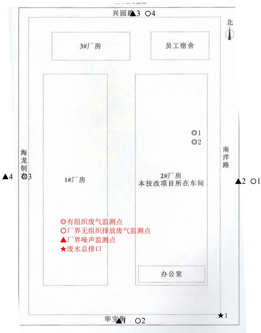
图 3-3 项目平面布置和监测点位示意图
