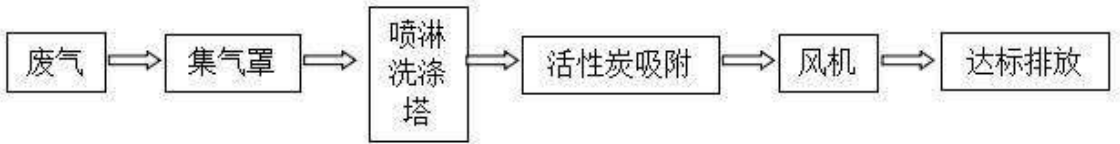
图 4-4 喷漆、烘道废气处理工艺流程图
