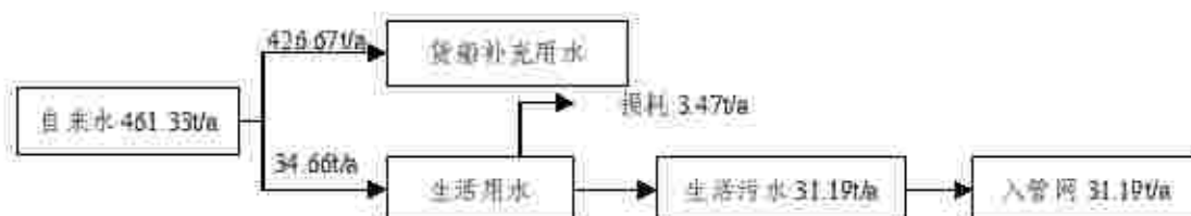
图 3-3 项目水平衡图
