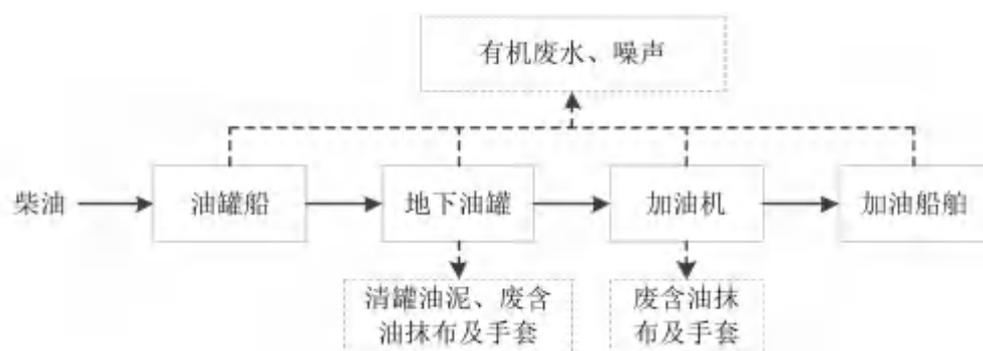
图 3.4-1 柴油加油工艺流程图
