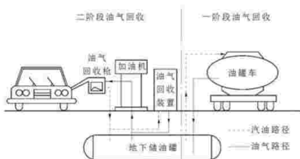
图 4.2 汽油油气回收实施方案原理图
