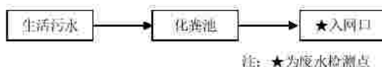
图 4-1 废水处理工艺流程
