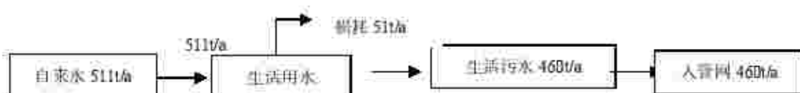
图 3-3 项目水平衡图
