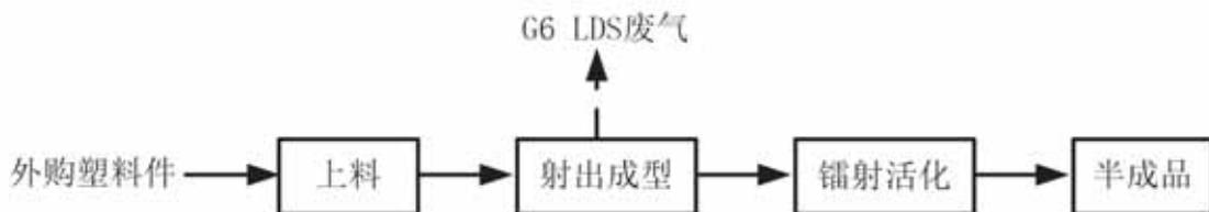
图 2-8 LDS 生产工艺流程图及产污节点图
