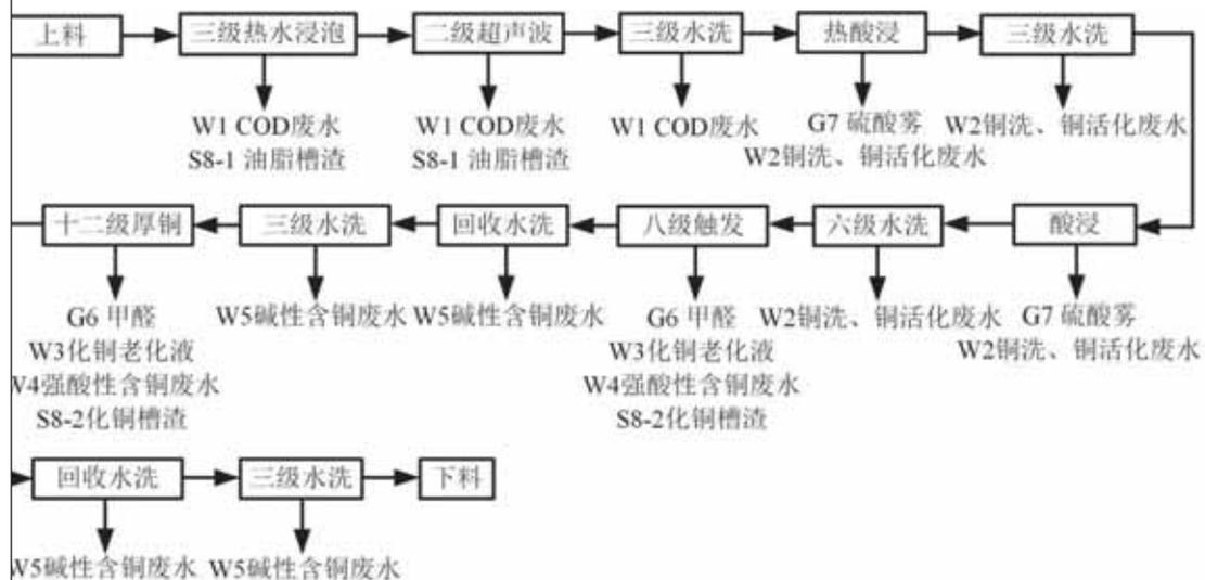
图 2-11 化学镀铜生产线工艺流程及产污节点图
