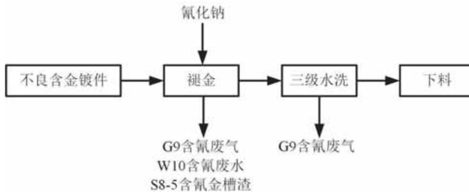
图 2-14 褪金工艺流程及产污节点图
