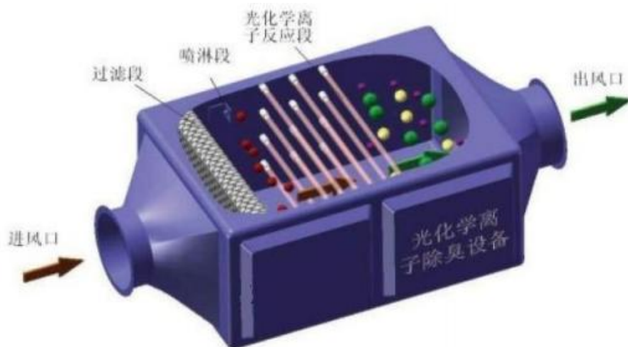
图82 光催化除臭内部结构示意图
