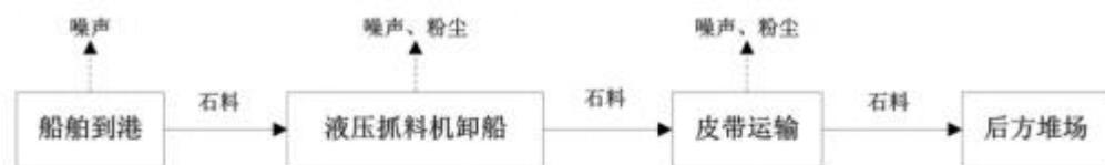
图 5-2 码头进口装卸工艺及产污环节图
