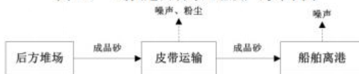
码头进出口装卸工艺及产污环节图
