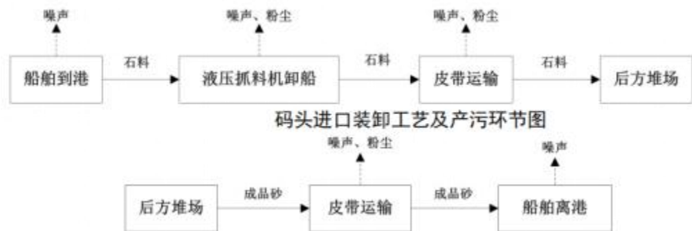
图 3-1 码头进出口装卸工艺及产污环节图
