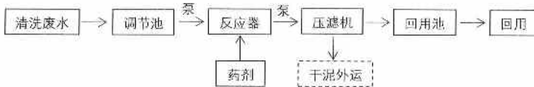
图 4-1 清洗废水处理工艺流程示意图
