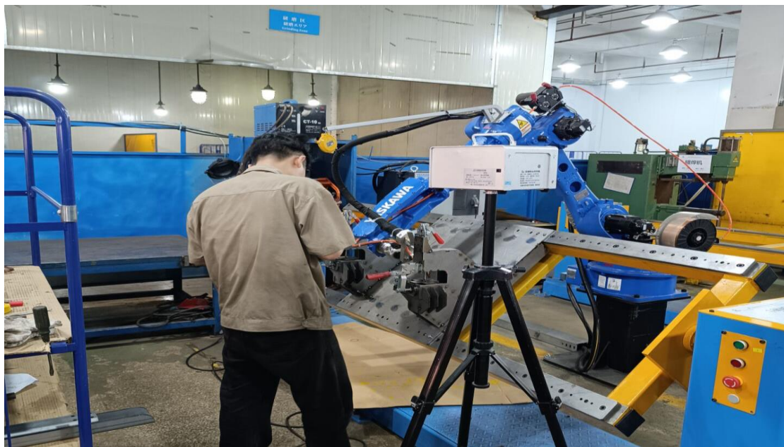
生产车间机器人气保焊岗位
