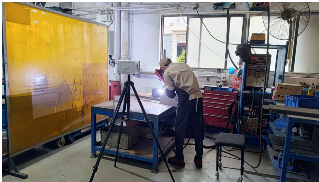
辅助车间气保焊岗位
