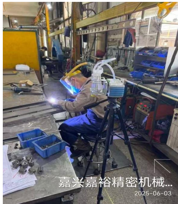
生产车间气保焊岗位
