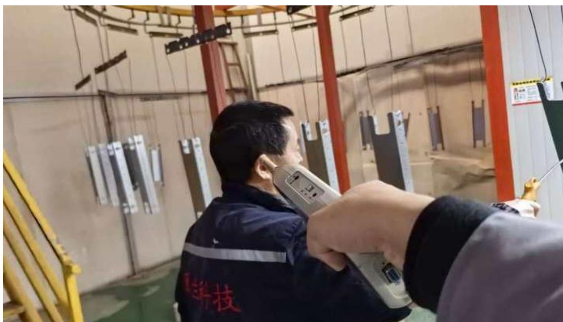
喷涂生产车间吹气岗位
