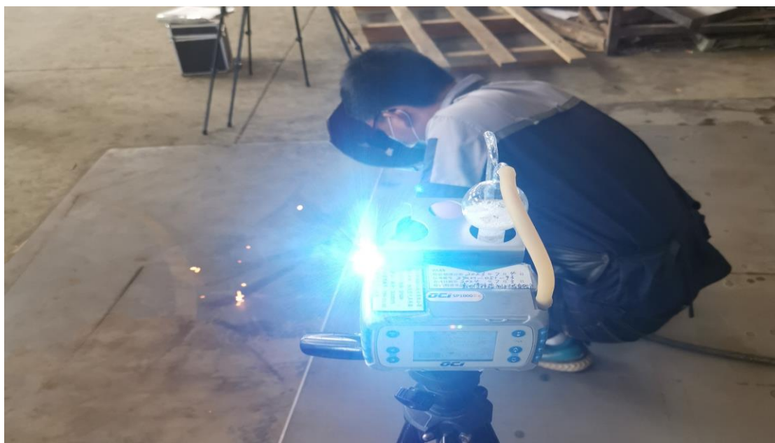
生产车间气保焊岗位
