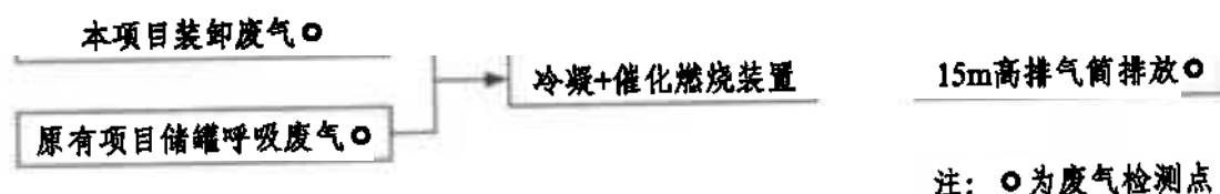
图 4-3 废气处理工艺流程图
