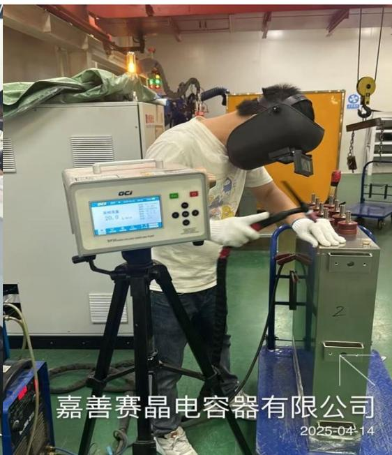
注胶车间手工电极氩弧焊岗位
