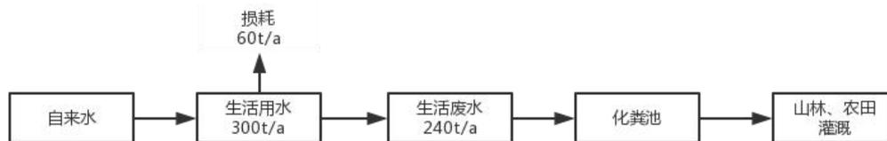
图 3-3 项目水平衡图
