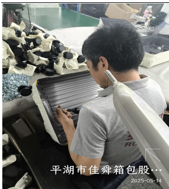
2楼组装车间组装打孔岗位
