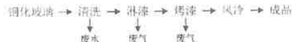
图 3-5 淋漆钢化玻璃工艺流程图及产污环节图
