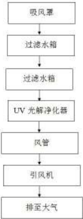
图 4-3 废气处理工艺流程图
