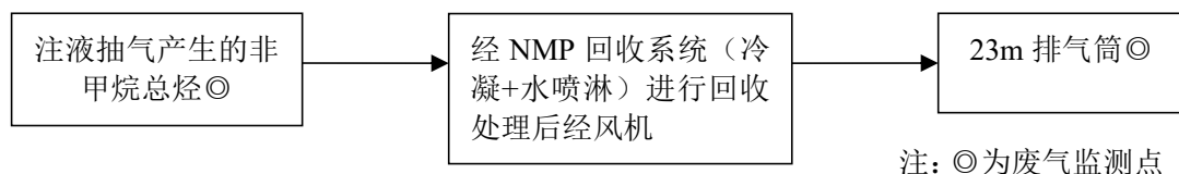
图 4-2 废气处理工艺流程图
