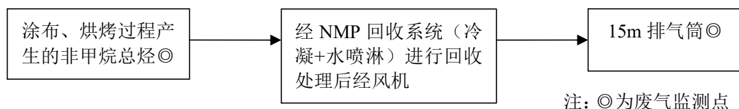
图 4-2 废气处理工艺流程图
