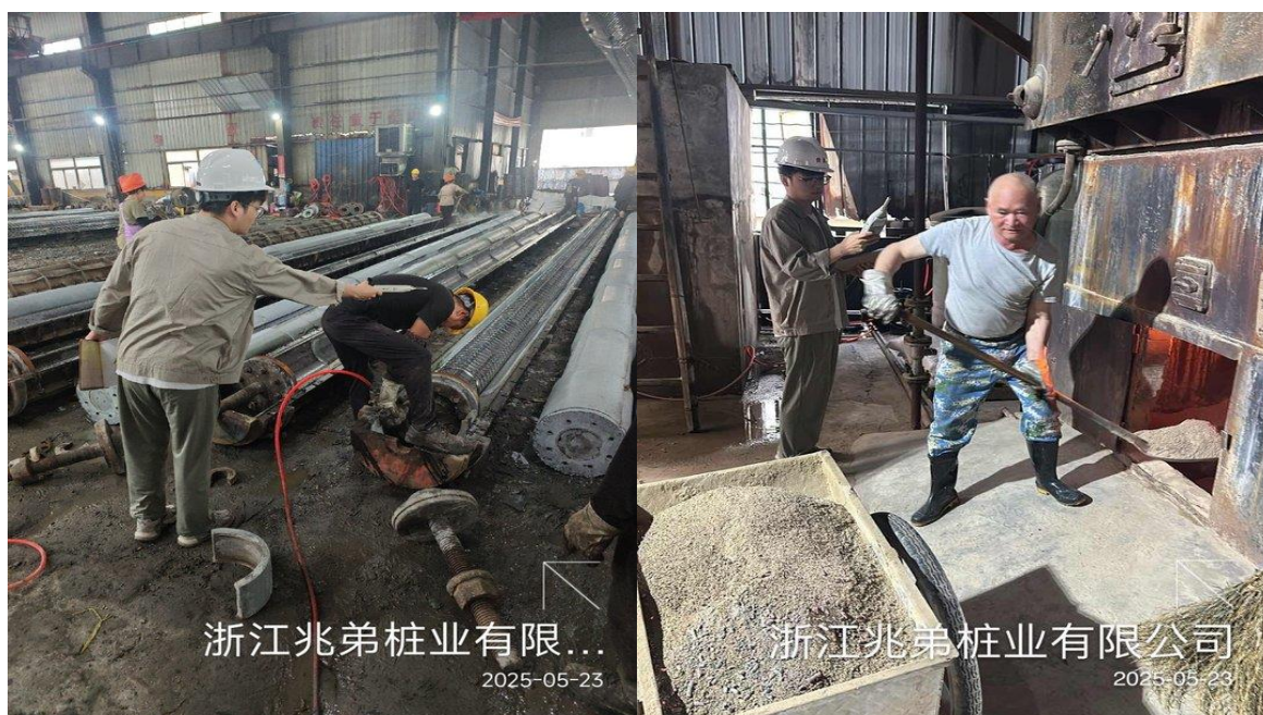
生产车间拆模岗位
