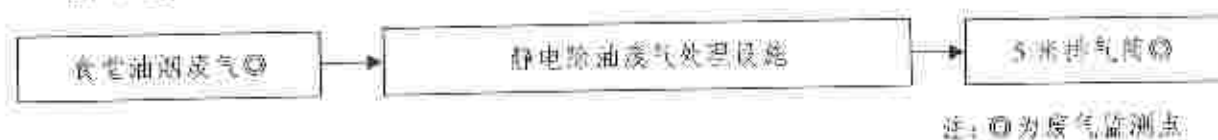
图 4-1 食堂油烟废气处理工艺流程图
