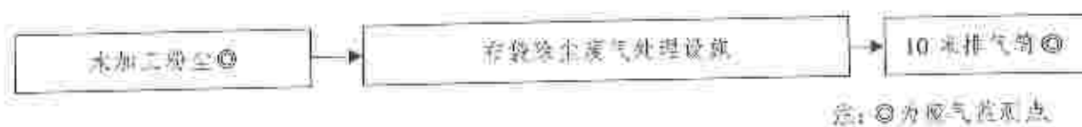
图 4-2 木加工粉尘处理工艺流程图
