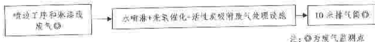
图 4-4 喷边工序和淋漆线废气处理工艺流程图
