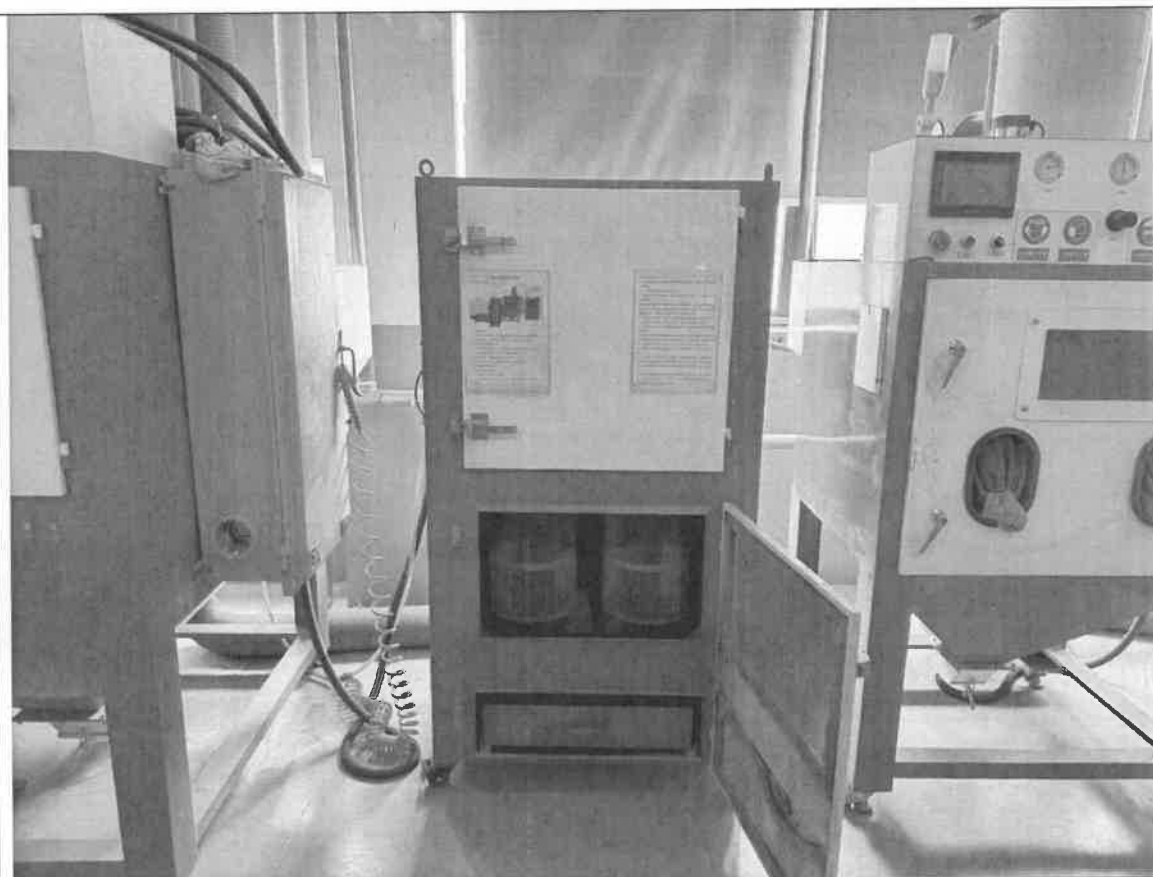
设备自带滤筒除尘（喷砂废气）
