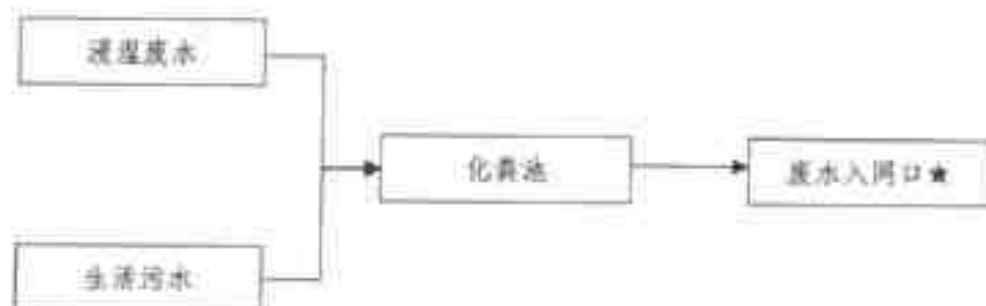
图 4-1 废水处理工艺流程
