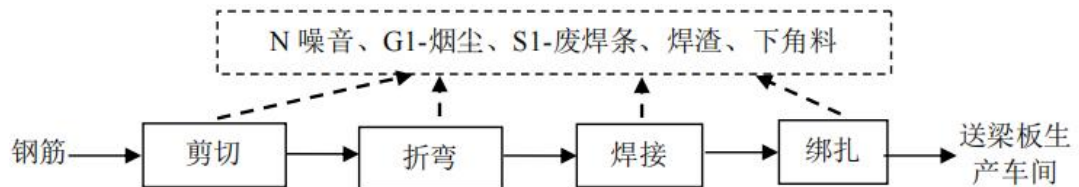
图 3-6 钢筋加工生产工艺及排污节点图
