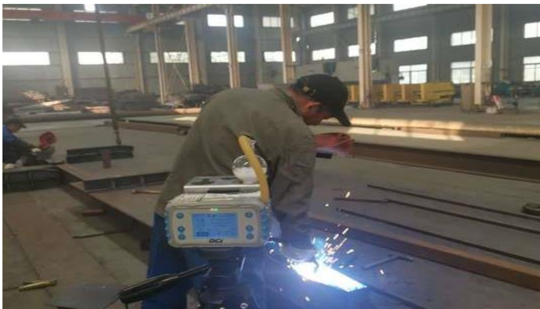
生产车间气保焊岗位
