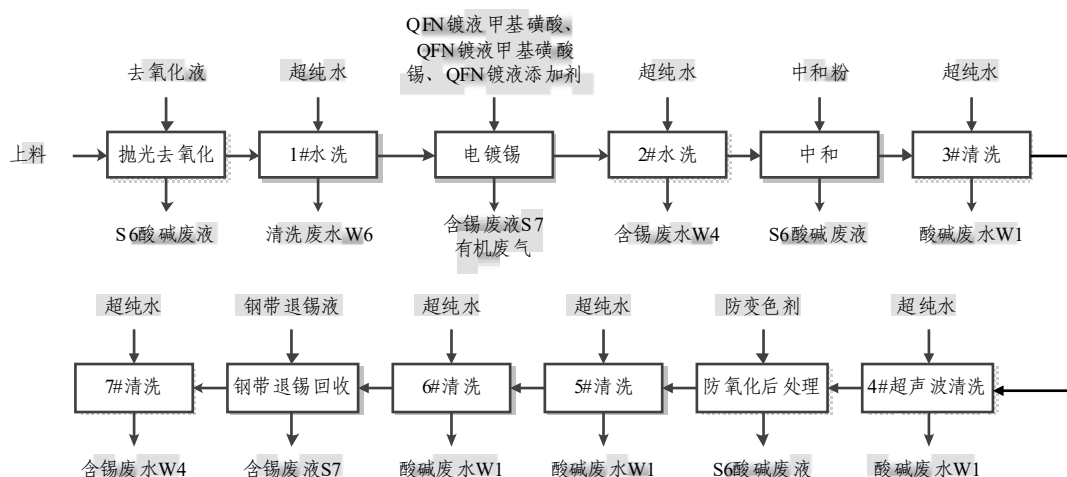
图 3-9 FC-QFN 封装电镀工艺流程图
