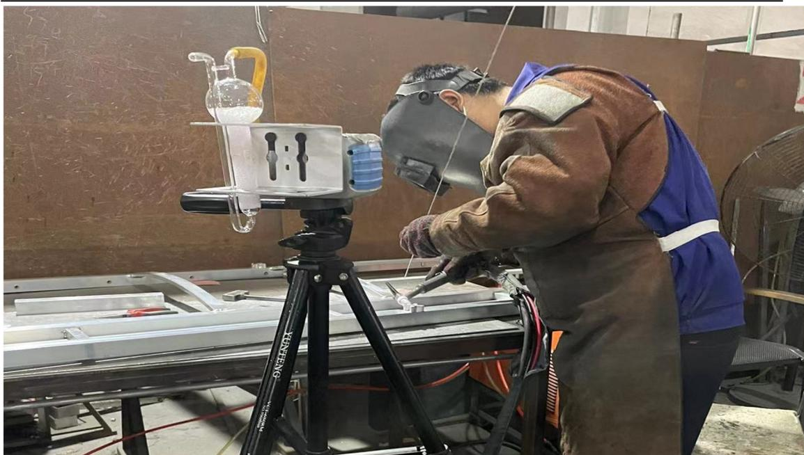
焊接车间手工氩弧焊岗位
