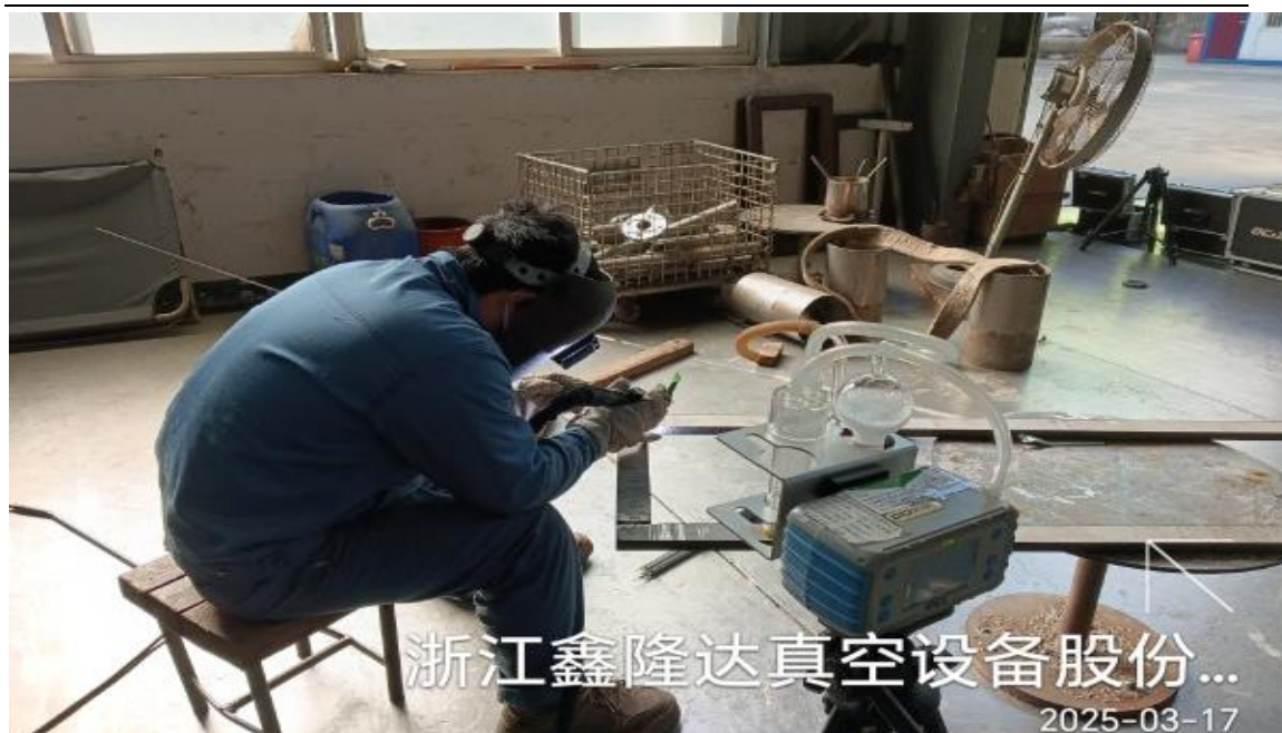
生产车间氩弧焊岗位
