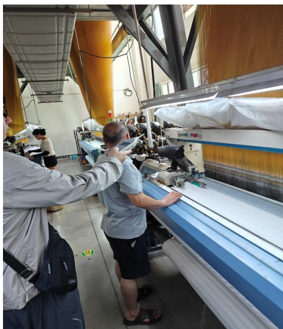
1 楼生产车间剑杆织造岗位
