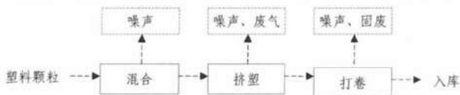
图 3-4 本项目生产工艺流程图及产污环节图
