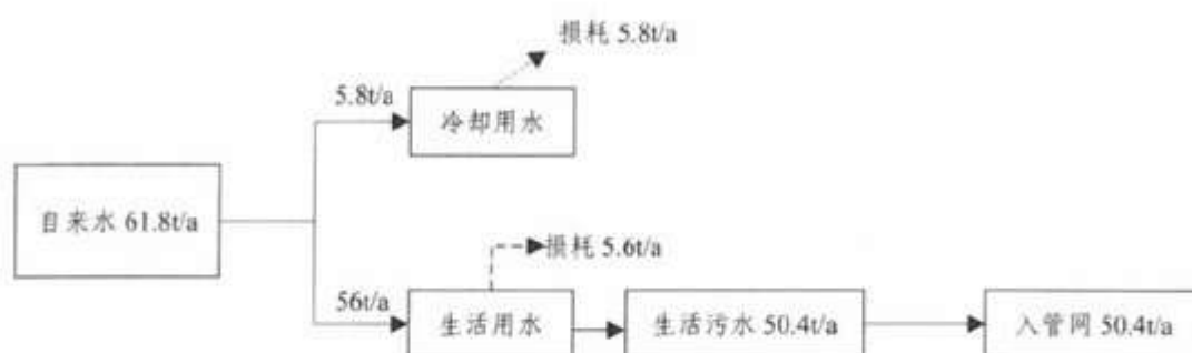
图 3-3 项目水平衡图
