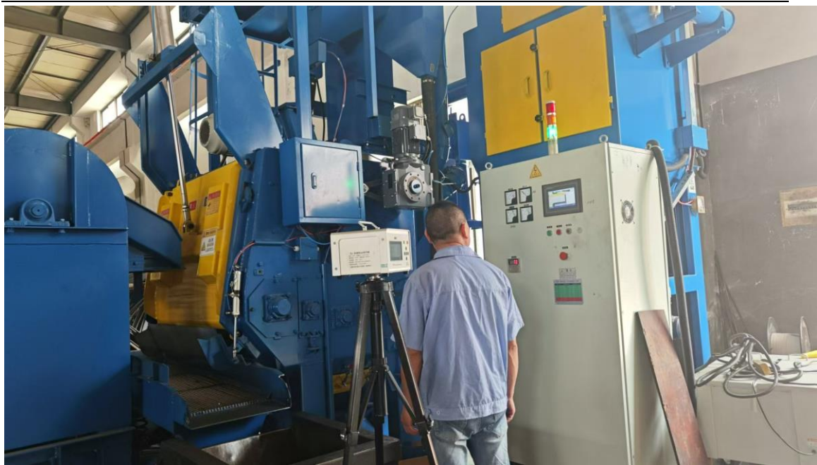
生产车间抛丸岗位
