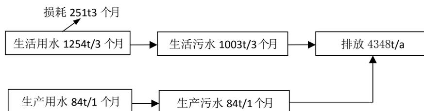
图 3-3 项目水平衡图
