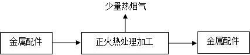
图 3-4 企业热处理加工工艺流程及产污环节图
