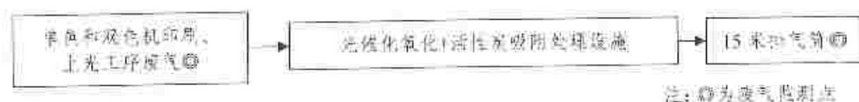
图 4-5 单色和双色机印刷、上光工序废气处理工艺流程图
