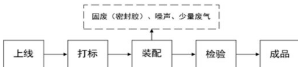
图 3-7 后副车架和控制臂总成工艺及产污环节流程图
