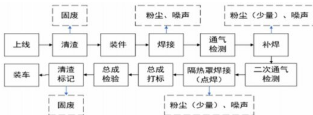
图 3-4 催化转化器总成焊接工艺及产污环节流程图
