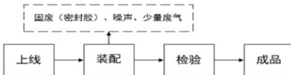
图 3-6 前副车架、控制臂和前制动总成工艺及产污环节流程图 工艺简介：
