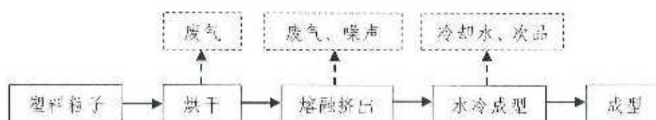
图 3-3 转椅塑料配件生产工艺流程及产污环节
