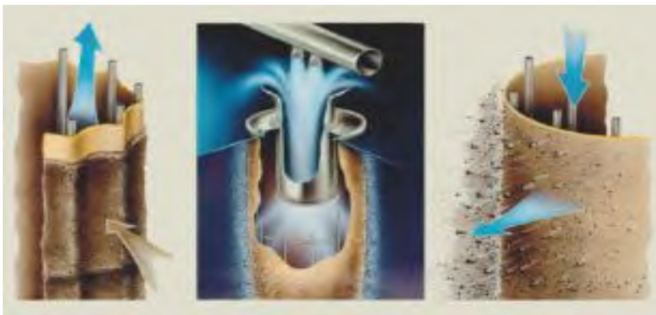
图 3 脉冲喷吹仿真模拟
