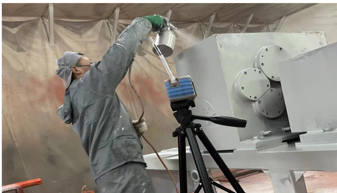
生产车间喷漆岗位
