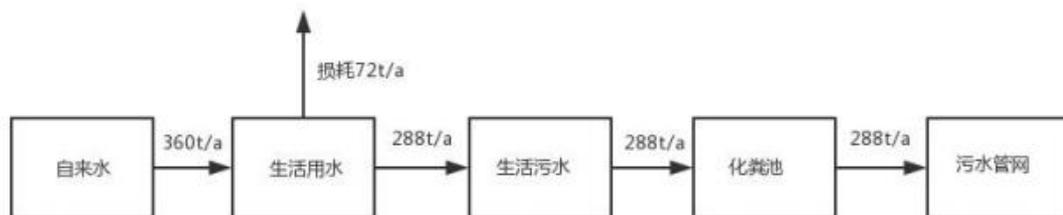
图 3-3 项目水平衡图
