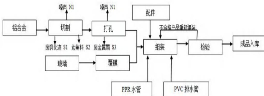
图 3-4 生产工艺流程及产污环节
