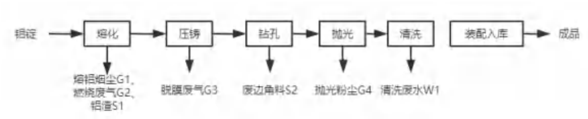
图 3-4 生产工艺流程及产污环节
