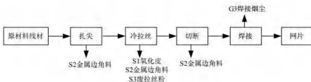
图 5-2 网片生产工艺流程和产污节点图
