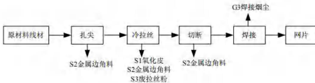
图 3-6 网片生产工艺流程和产污节点图
